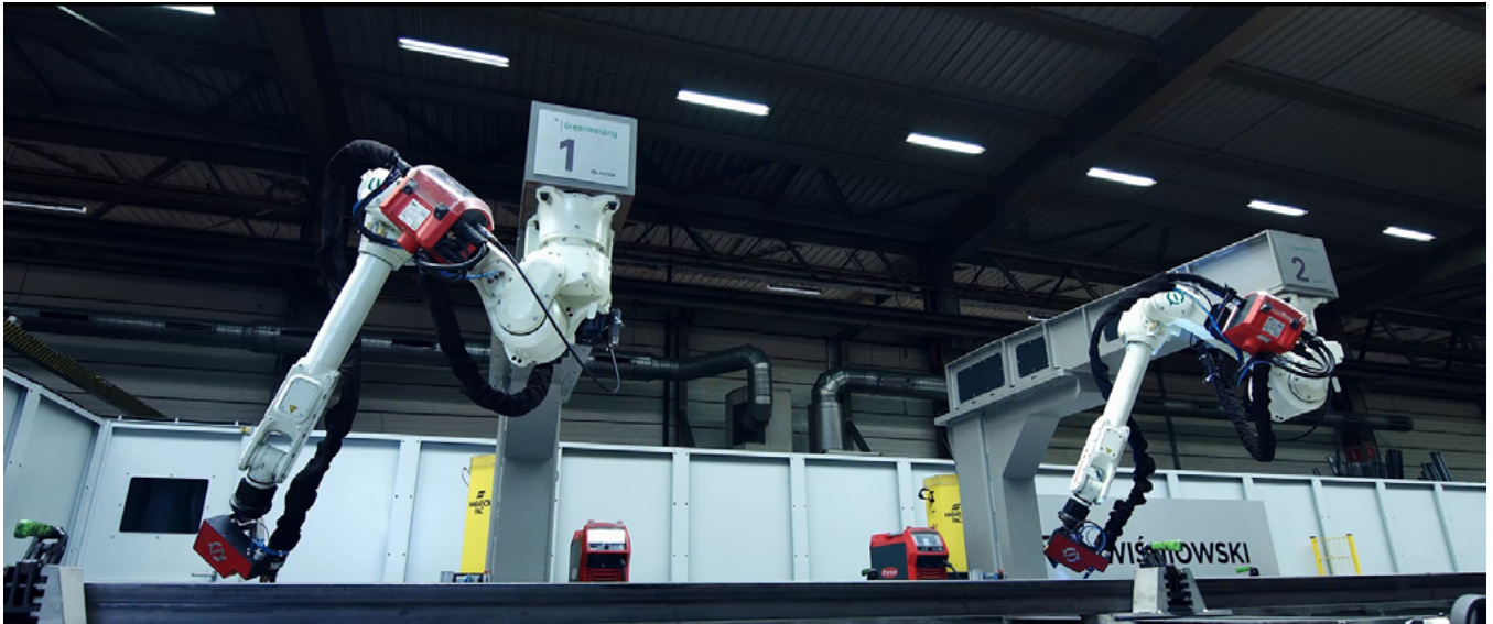
👁 Pracovní stanice ASTOR Green Welding - průmyslové roboty Kawasaki RA006L
